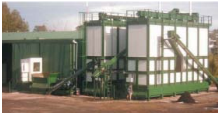
Una Unità di Compostaggio Verticale (o UCV). I siti UCV in Australia e Nuova Zelanda trattano un'ampia varietà di materiali organici: incluso i rifiuti verdi, alimentari, carta e liquami fognari.
